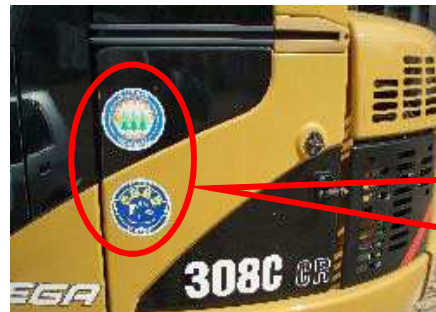
使用重機 (低騒音型重機)
