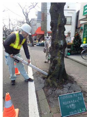
精密診断（レジストグラフによる根株診断）
