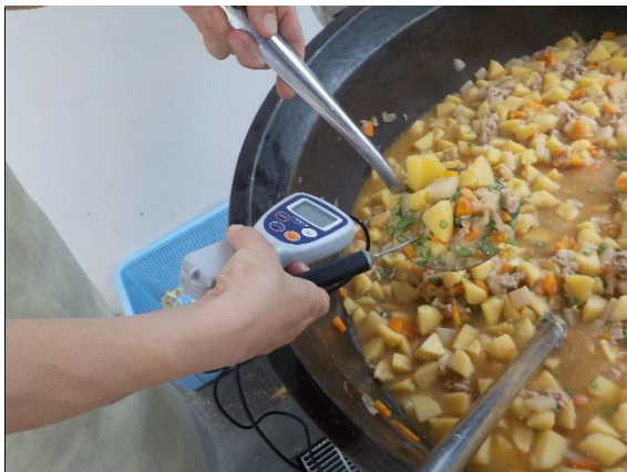
りょうり ちゅうしんおんど かくにん 料理の中心温度を確認
