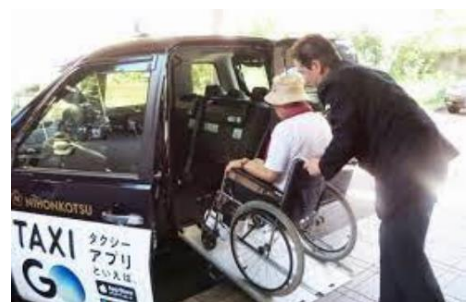
車いすのまま乗車可能な ユニバーサルデザインタクシー
