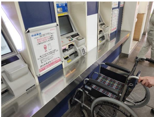
脚を入れる空間を設けた券売機
